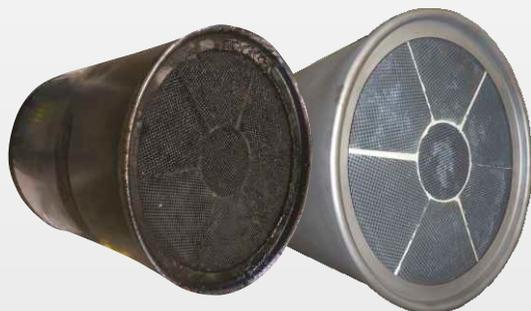
Rußpartikelfilter (DPF) unterliegen einem kontinuierlichem Verschleiß. Die Laufzeit hängt maßgeblich davon ab, ob das Fahrzeug auf Kurz- oder Langstrecken eingesetzt wird. Um teure Folgeschäden zu vermeiden, wird eine professionelle DPF Reinigung erforderlich, sobald der Gegendruck im Filter ansteigt.
