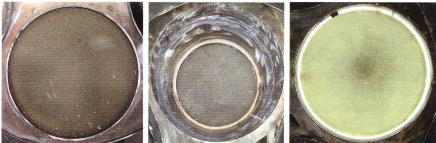
Vorher-nachher: Bei SCR-Abgasreinigungssystemen kann der Harnstoff („AdBlue“) kristallartige Rückstände in den feinen Kanälen bilden, die den Abgasdurchfluss behindern und die Reinigungswirkung beeinträchtigen (links). Bei dem von Irosoft-Cleantech angebotenen Instandsetzungsverfahren wird zunächst das defekte Keramikmodul entfernt (Mitte) und schließlich durch ein neues Modul ersetzt (rechts). Manche SCR-Katalysatoren verfügen über bis zu sechs Module. Bilder: Irosoft-Cleantech
