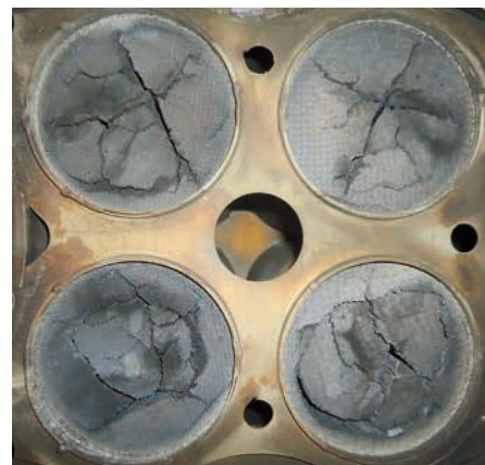
Defekte Filterkeramik nach Turboladerschaden. Das heiße Motoröl verursacht irreparable Schäden.
