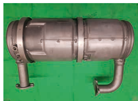
Strahlend sauber. Nach der Reinigung und der optischen Aufbereitung sind die Filter praktisch neuwertig.
